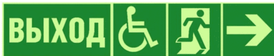
Рисунок 5 - Пример комбинации эвакуационных знаков
